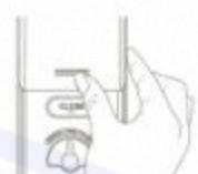
Откройте крышку отсека для батарей на внутреннем блоке.
