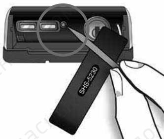
Если ничего не происходит после нажатия клавиши открытия крышки сенсора или прикосновения к панели набора, нажмите кнопку сброса для перезагрузки замка.
