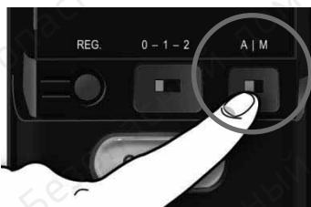
Установите рычаг автоматического/ручного запирания в положение ‘A’.
