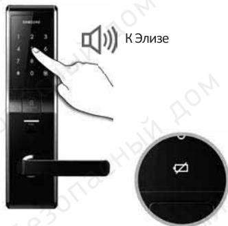
Если Вы услышали мелодию “К Элизе” после открытия двери, пришло время заменить элементы питания (Индикатор низкого заряда элемента питания будет подсвечен на нижней панели устройства).
