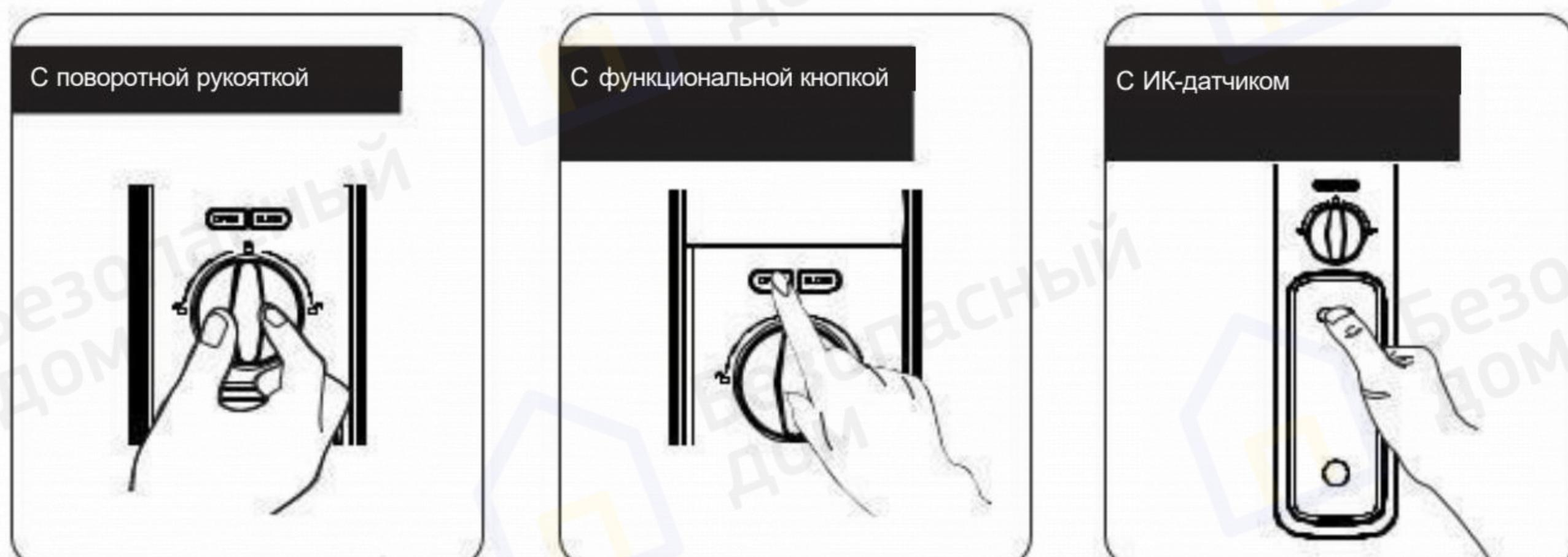
В Philips Easykey используется внутренний врезной быстро открывающийся замок. Вы можете отпереть дверь изнутри, повернув поворотную рукоятку.
