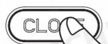
При установке замка в Ручной режим заглушка автоматически не срабатывает после закрытия двери. Только после двойного нажатия кнопки [CLOSE] в течение одной секунды заглушка может всплыть и заблокировать дверь. После того, как дверь заблокирована, вы услышите голосовую подсказку "Door closed".
