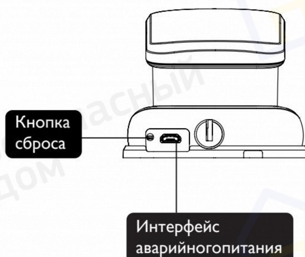
Если напряжение батареи недостаточно, и дверь не может быть открыта снаружи, вы можете включить замок через интерфейс Micro USB, используя 5V блок питания в качестве аварийного источника питания. После открытия дверного замка немедленно замените батареи. В случае сбоя системы и невозможности открыть дверь снаружи, нажмите кнопку Reset (Сброс), а затем отпустите кнопку, чтобы разрешить ее автоматическую перезагрузку.
